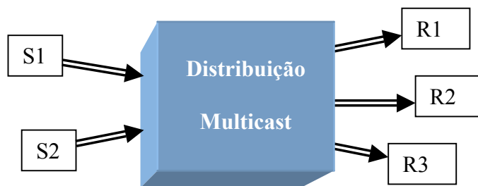
Figura 3.1.1.a - Sessão multicast , Si's são os transmissores e Ri's os receptores
